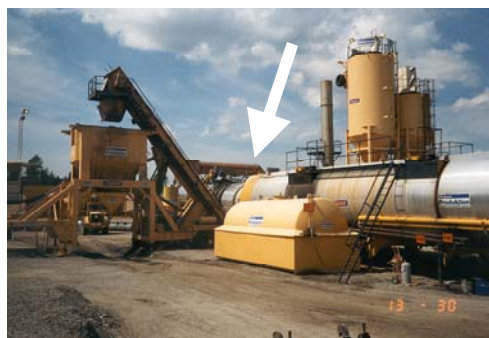
Bild 9-3 Trumblandningsverk. Granulatet tillsätts i slutet av torktrumman, innan blandaren (se pilen). I trumblandningsverk kan upp mot 50 % granulat inblandas.
