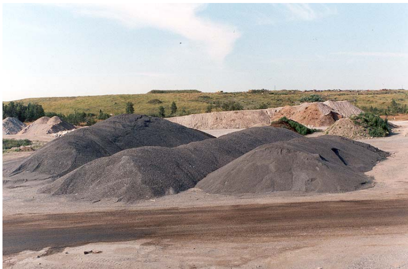
Bild 9-5 Sorterat granulat för varm återvinning. I upplagen till vänster förvaras fin- resp. grovsortering av ABT-massor medan upplaget till höger består av ABS-massor.
