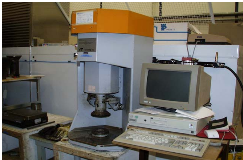
Bild 8-9 Gyratorisk packningsutrustning för tillverkning av provkroppar.
