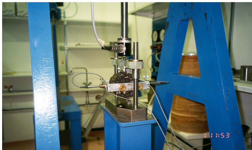
Bild 8-11 Mätning av styvhetsmodul. Vid metoden används en pulserande last.
