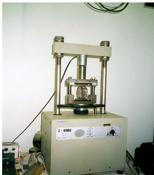
Bild 8-10 Mätning av pressdraghållfasthet (vänster) och Marshallstabilitet (höger). I båda fallen används samma apparat men olika provriggar.
