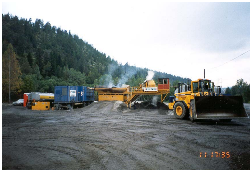
Bild 8-2 Tillverkning av halvvarma massor i satsblandningsverk med ånguppvärmning.
