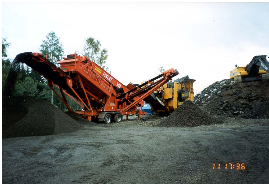
Bild 8-4 Krossning och sortering av asfaltgranulat.
