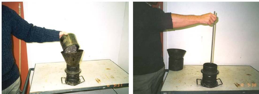
Bild 7-12 Innan provet packas i statisk press förpackas massan med en stav (20 slag utmed kanterna och 20 slag i mitten av formen). På så sätt kan partiklarna orientera sig i formen innan den statiska lasten läggs på som packar ihop materialet.
