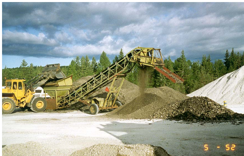
Bild 7-5 Grovsortering av asfaltgranulat. Klumpar större än 22 mm tas bort.
