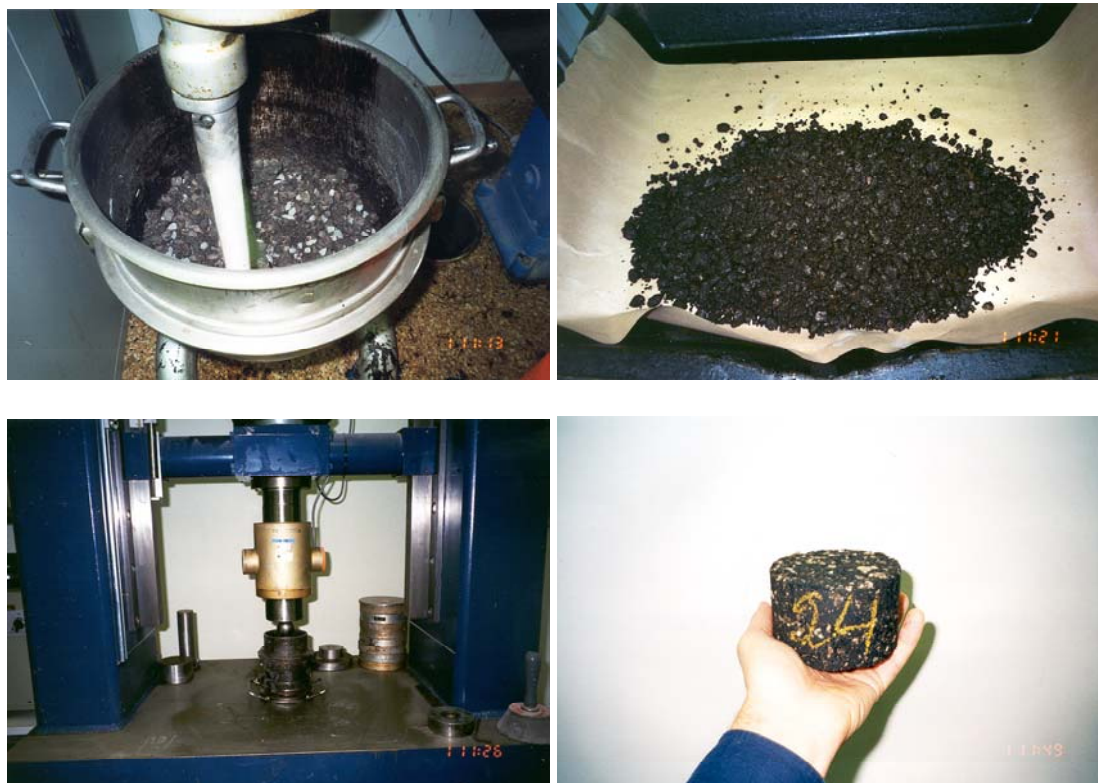
Bild 7-11 Preparering av provkroppar genom blandning i Hobart (degblandare) och statisk packning.
