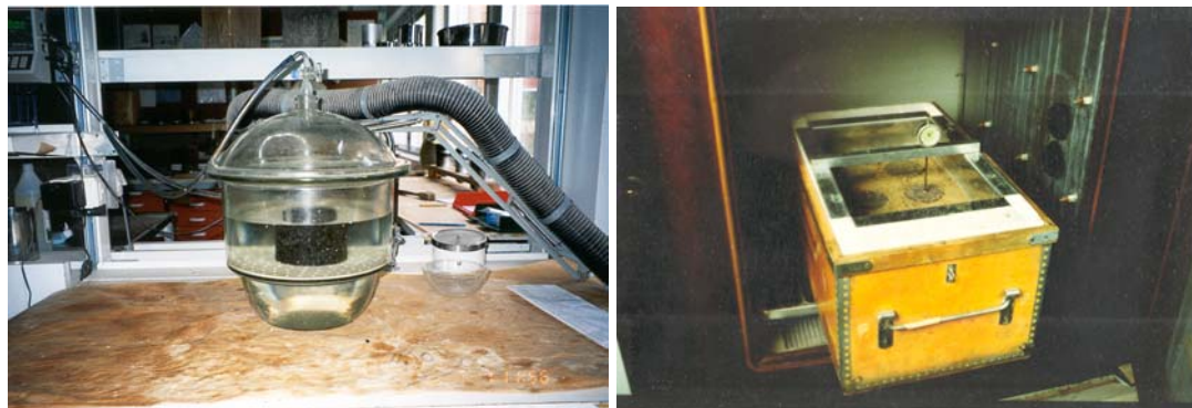
Bild 7-13 Vattenlagring av provkroppar och fryslåda för frys-töförsök.
