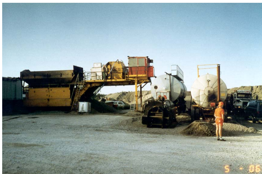
Bild 7-4 Blandningsverk för satsvis tillverkning av kallblandad massa.
