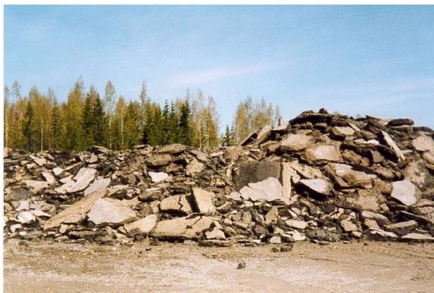
Bild 5-1 Uppgrävda asfaltmassor i mellanlager.
