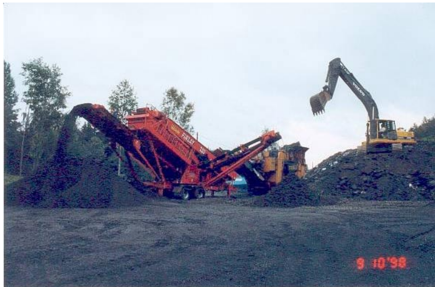
Bild 3-3 Krossning av returafalt till asfaltgranulat.
