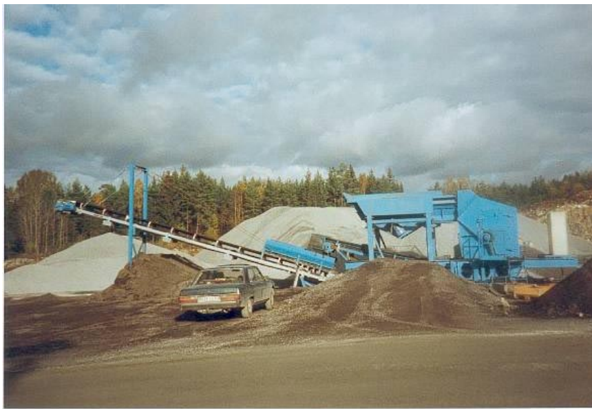
Bild 3-4 Granulator för skonsam sönderdelning av returafalt.
