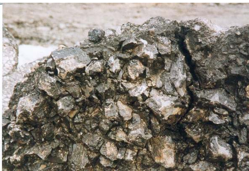
Bild 2-1 Gammal indränkt makadam innehållande stenkolstjära i upplag.
